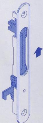
Régler le crochet en profondeur
