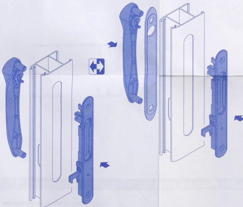
**5** Placer puis serrer les 2 vis de fixation
