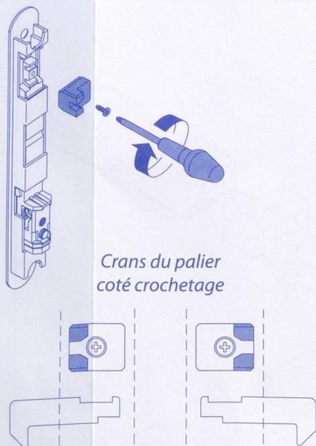
**2** Mettre en place le crochet (Placer le crochet en bout de fente, faire ressortir la vis de réglage, plaquer le crochet contre la vis et régler le crochet à l'aide d'un tournevis 6 pans de 3mm).
