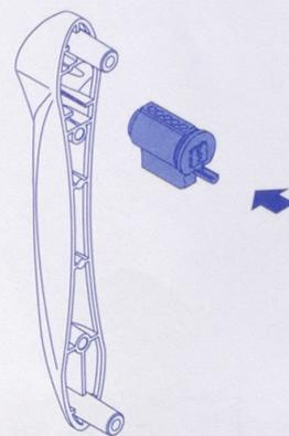
**4** Placer le mécanisme intérieure et la poignée extérieure (avec la platine si nécessaire) sur le profil
